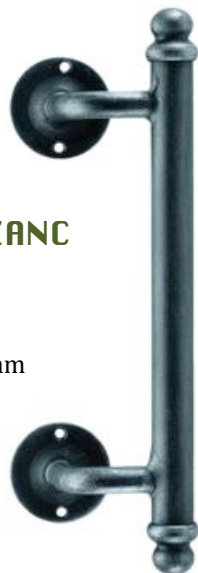
Art.2114/ZANC Gekröpfte Länge: 210 mm Griff: Ø16 mm Rosetten: Ø40 mm
